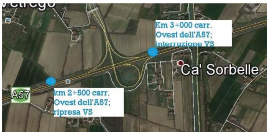
Schema Grafico 8 – Interruzione/ripresa via di sicurezza in carr. OVEST in prossimità del casello di Mirano-Dolo
