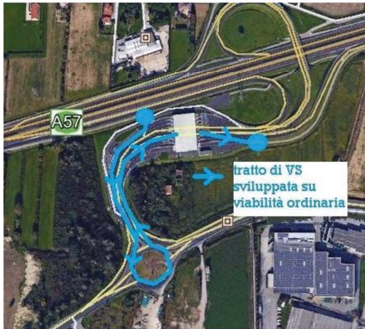
Schema Grafico 5 – Via si sicurezza in carr. EST in prossimità di Mira – Oriago tratto percorribile solo nel senso indicato
