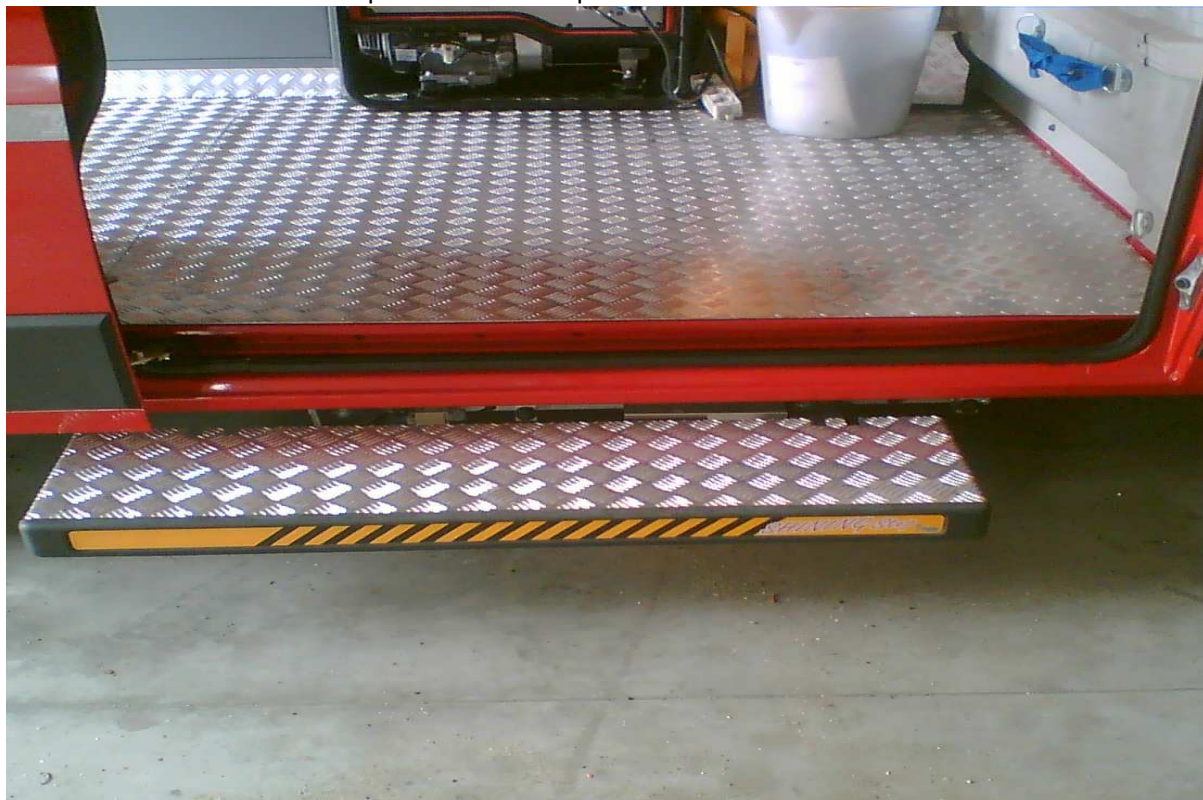
Foto 5: allestimento interno – pedana retrattile portellone laterale
