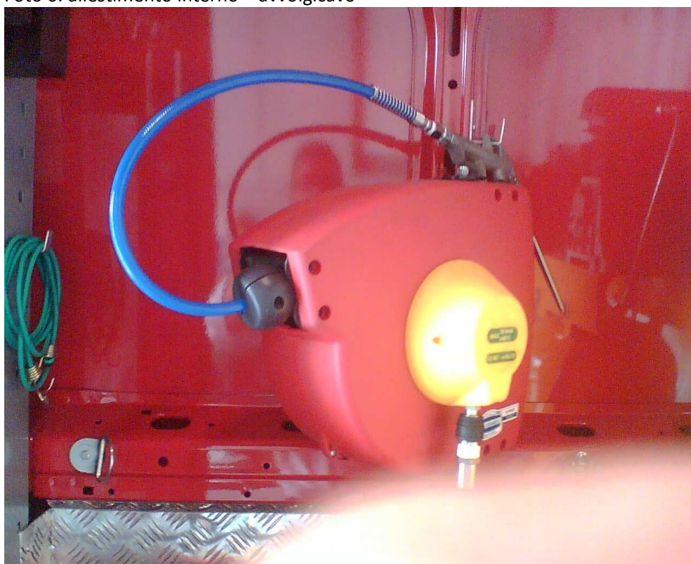
Foto 6: allestimento interno – avvolgicavo
