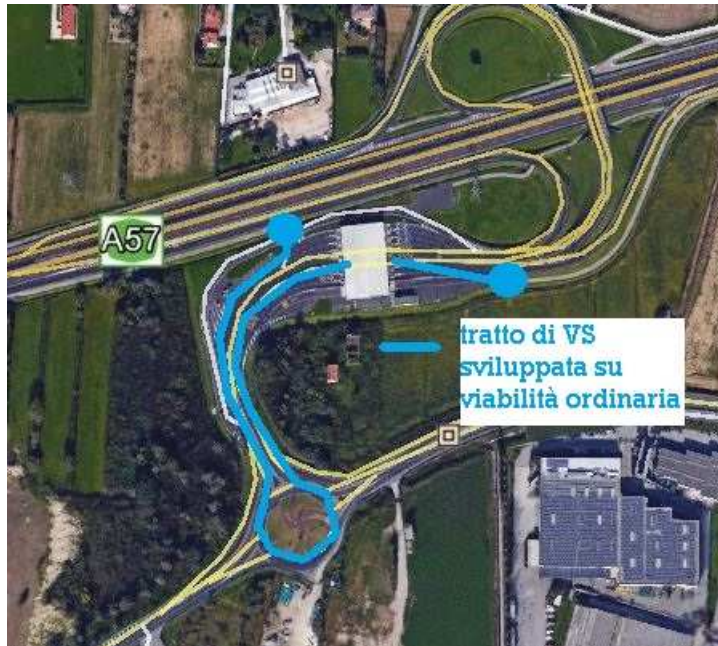
Schema Grafico 5 – Via di sicurezza in carr. EST in prossimità di Mira - Oriago
