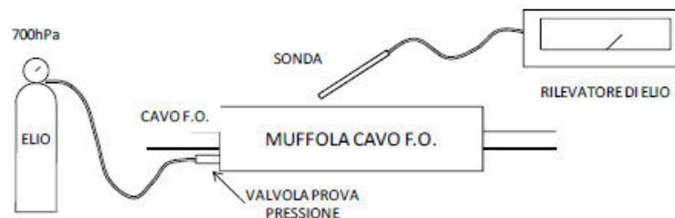
Figura 7 - Schema di misura della tenuta pneumatica delle muffole.
