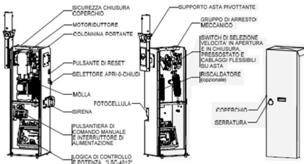
Le barriere elettromeccaniche oltre ai meccanismi di movimento sono dotate di:
