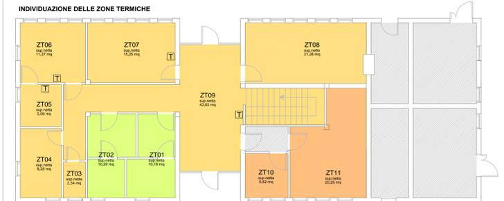
Pianta piano terra - edificio di stazione
