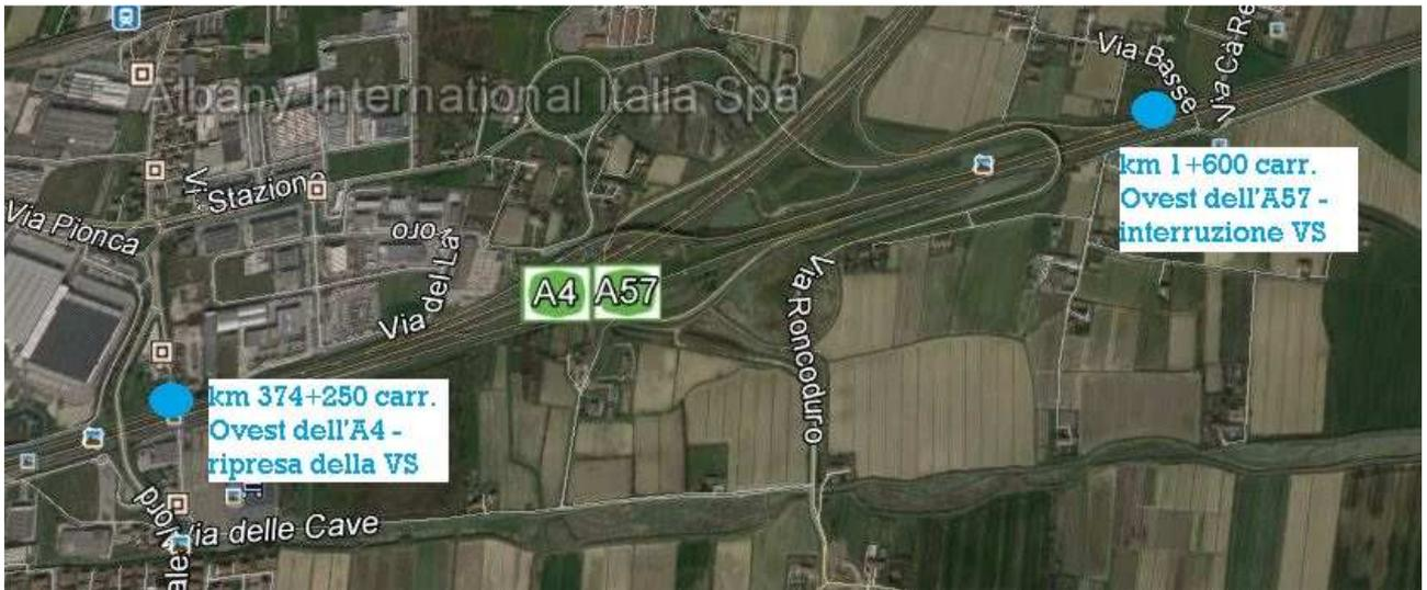
Schema Grafico 9 – Interruzione/ripresa via di sicurezza in carr. OVEST in prossimità del bivio A57/A4
