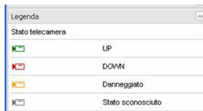
Figura 58 – Legenda dello stato delle telecamere
